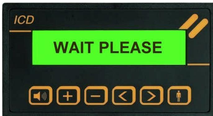
Diese Anzeige bleibt nach dem Einschalten und am Ende des Programmierens ca. 2 Sekunden bestehen.
