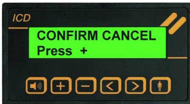
Erfolgt innerhalb von 5 Sekunden keine Bestätigung wird der Vorgang beendet.
